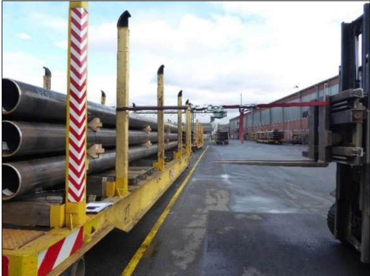
Abbildung 3, Zugversuch an Runge eines Mafi
