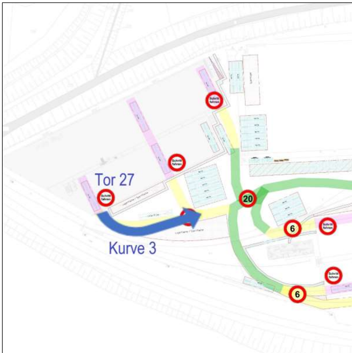
Abbildung 31, Lageplan Kurve „K3“ Bem.: Mafi-Werkstatt, nur unbeladen. Geschwindigkeit: 6 km/h
