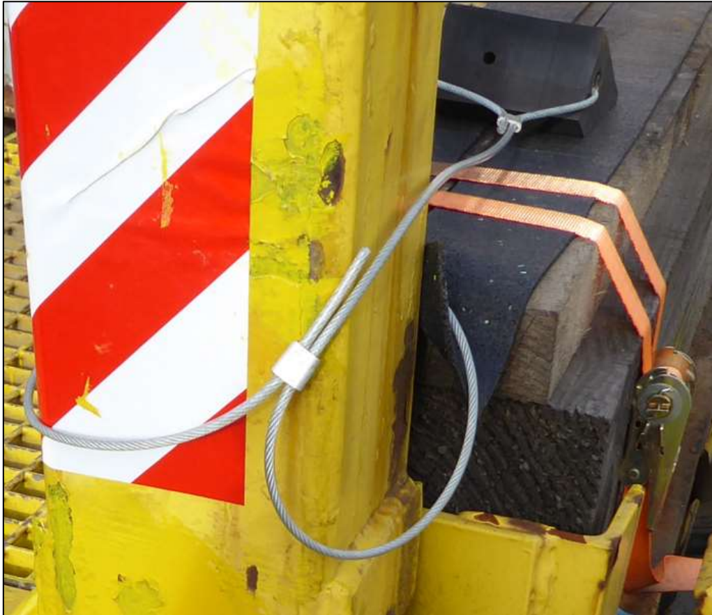
Abbildung 7, Sicherung Auflagebalken, Gummikeile für erste Rohrlage, Beispiel Mafi 26
