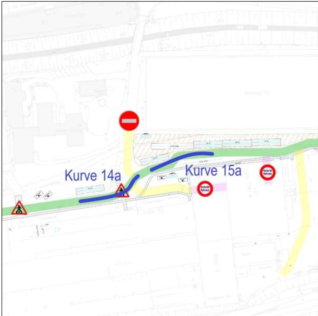
Abbildung 45, Lageplan Kurve „K14a“ & „K15a“ Geschwindigkeit: 20 km/h. Bem.: „a“ ohne bes. Bedeutung, Kurven werden immer zusammen befahren.
