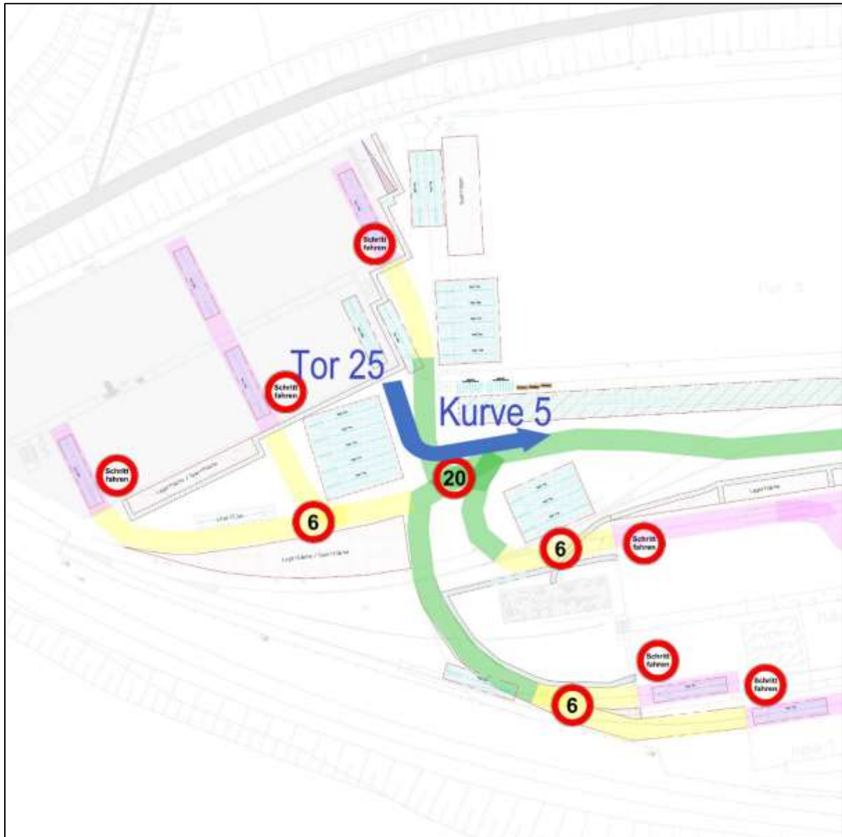
Abbildung 35, Lageplan Kurve „K5“ Bem.: K5 mündet in K6. Geschwindigkeit: 6 km/h
